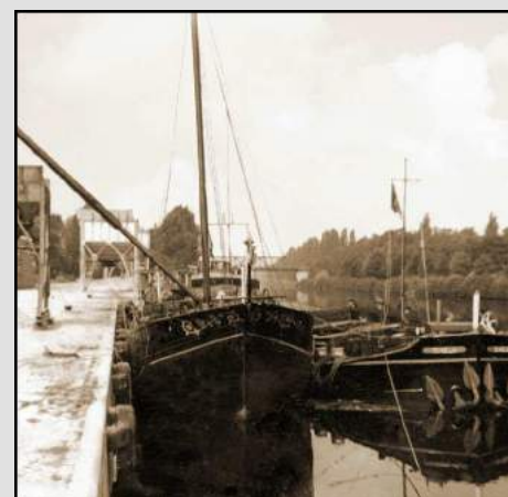
Hier ligt de Alberdiena aan de kade, een lading zand of grind innemend. Volgens de meetbrief was het laadvermogen van de (nog onverlengde) Alberdiena ongeveer 100 ton.
